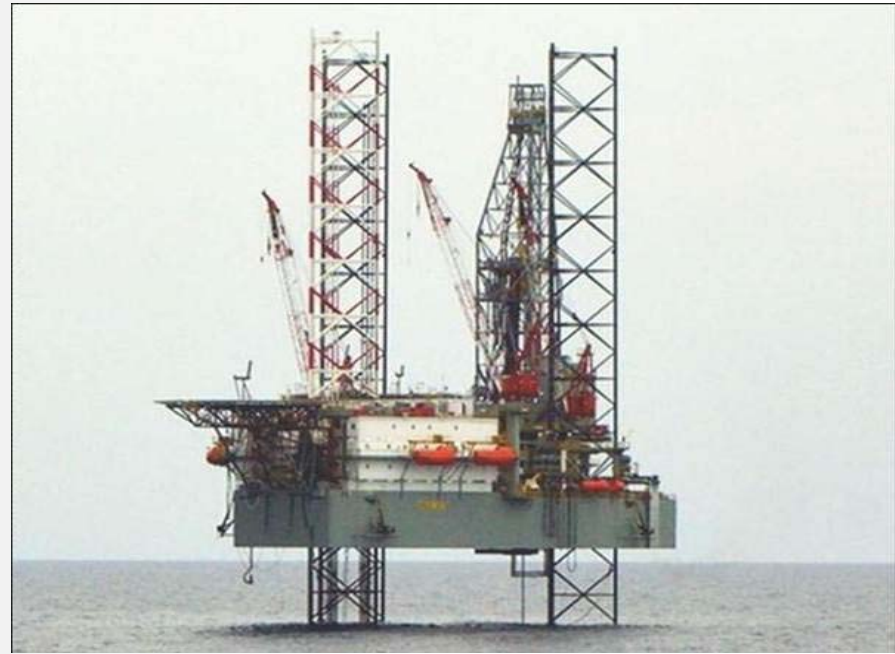
แท่นเจาะชนิดที่ยังติดพื้นทะเลแบบยกตัวได้ (Jack-up rig)
