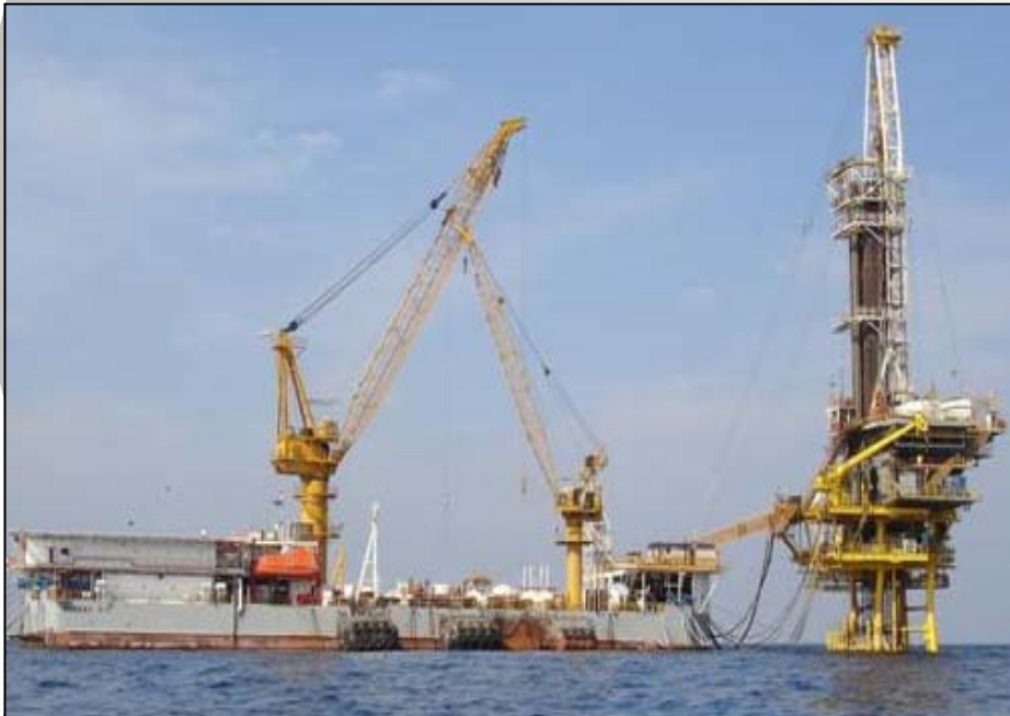
แท่นเจาะชนิดลอยที่มีลักษณะเป็นเรือเจาะ (Tender rig)
