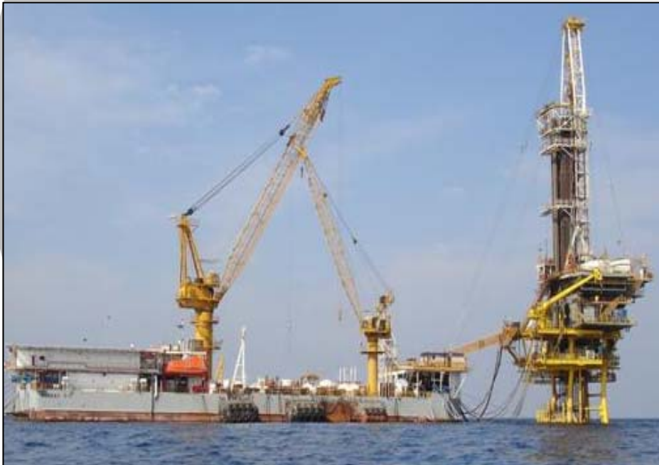
แท่นเจาะที่มีเรือ Barge สนับสนุน (Tender rig)
