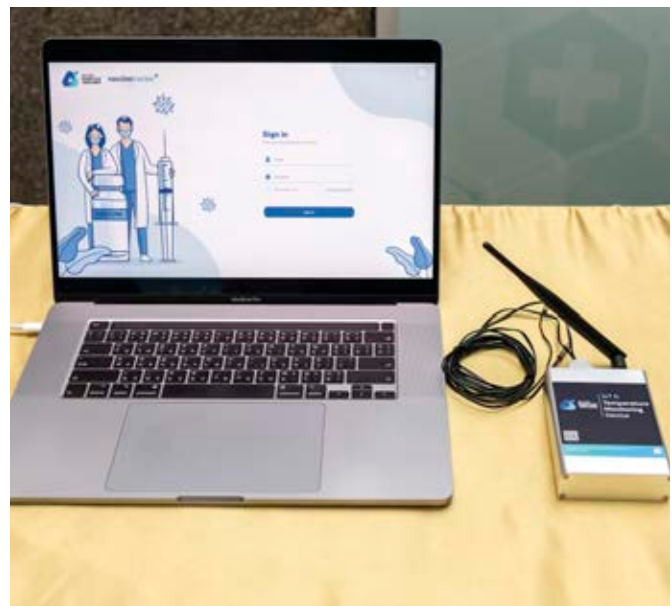
ชุดอุปกรณ์ระบบตรวจวัดอุณหภูมิตัวเก็บวัดคลื่นโควิด 19 และควบคุมห้องไอความเย็น
